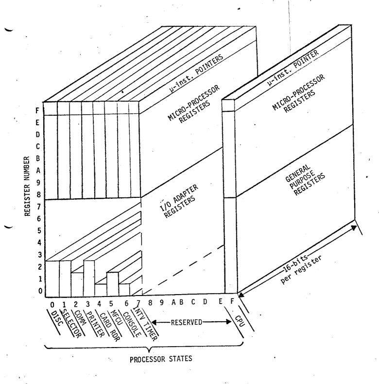
FIGURE .I 7100 SYSTEM REGISTER FILE
